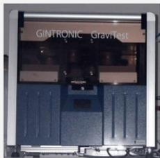
*Perméamètre Gravimétrique automatisé Gintronic*
