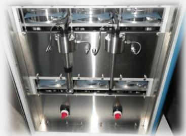
*Perméamètre fluxmétrique Versaperm*
